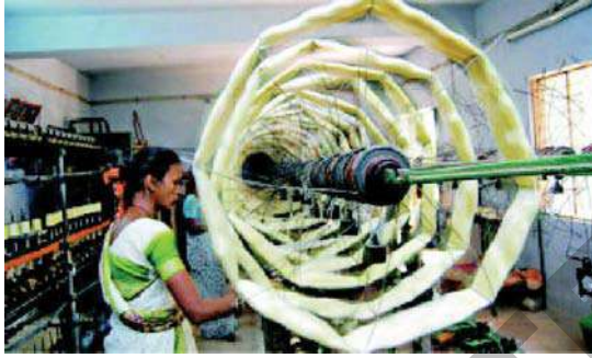
توقون کے دھاگے کے جانبی سروں کو چرخوں پر لپیٹنا شکل-6
